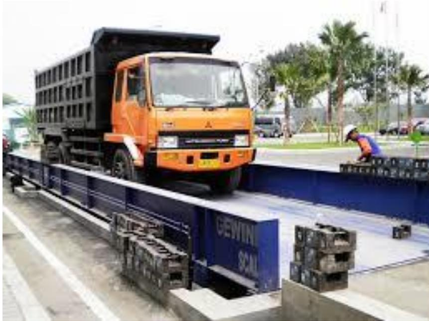
Tahukah kamu apa gambar di atas? Gambar tersebut merupakan Jembatan Timbangan Mobil. Apa itu jembatan timbangan mobil? Jembatan timbangan mobil adalah sebuah alat yang digunakan untuk menimbang berat kendaraan beserta muatannya. Hal ini berguna untuk mengukur besarnya muatan pada industri, pelabuhan ataupun pertanian dan berguna untuk menjaga mobil agar beratnya tetap seimbang.
